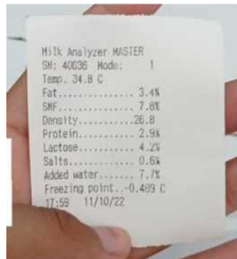
Gambar 7. Hasil uji kualitas susu menggunakan Lactoscanmilk
